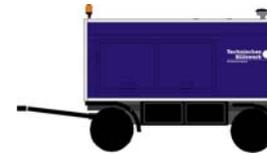
Seit 2008 steht dem Ortsverband eine POLYMA-175 kVA-Netzersatzanlage zur Verfügung. Die Anlage kann Großschadensstellen mit Strom versorgen durch den Aufbau eigener Stromnetze über Baustromverteiler. Eine Netzeinspeisung ist auf Weisung und nach Absprache mit den Energieversorgern möglich. Speziell geschulte Maschinisten bedienen die Anlage.
